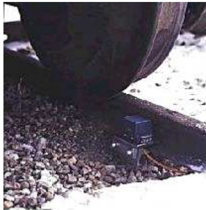
Figura 3. Fotografia di un sensore di prossimità ad induzione elettromagnetica.
